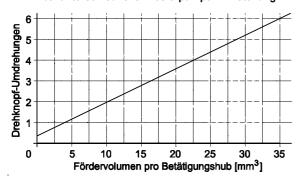
Abb.2: Förderleistung einer Dosierpumpe bei unterschiedlicher Dosierpumpen-Einstellung und Frequenz.
